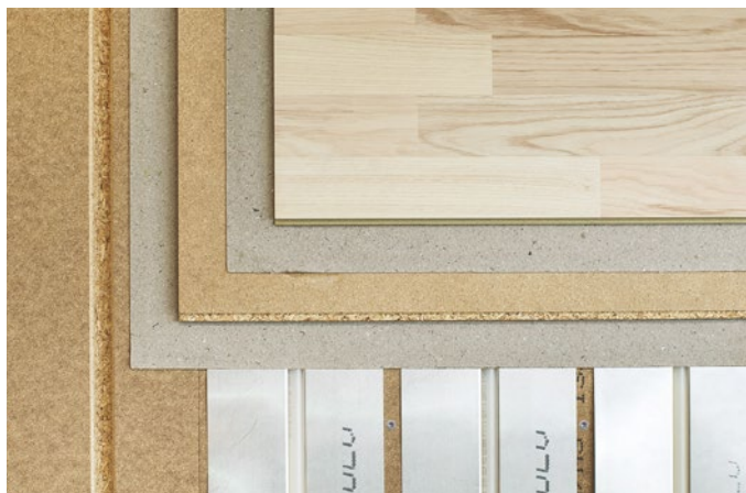
Figur 12 Man skall alltid lägga golvpapp mellan värmefördelningsplattor och undergolvskivor, samt mellan undergolvskivor och trägolv för att undvika knarr- och gnisselljud. Där undergolvsskivor skruvas fast i klimagolvet skall skruvarna placeras enligt Faktablad #17S Mellanläggsskivor för klimatgolv .
